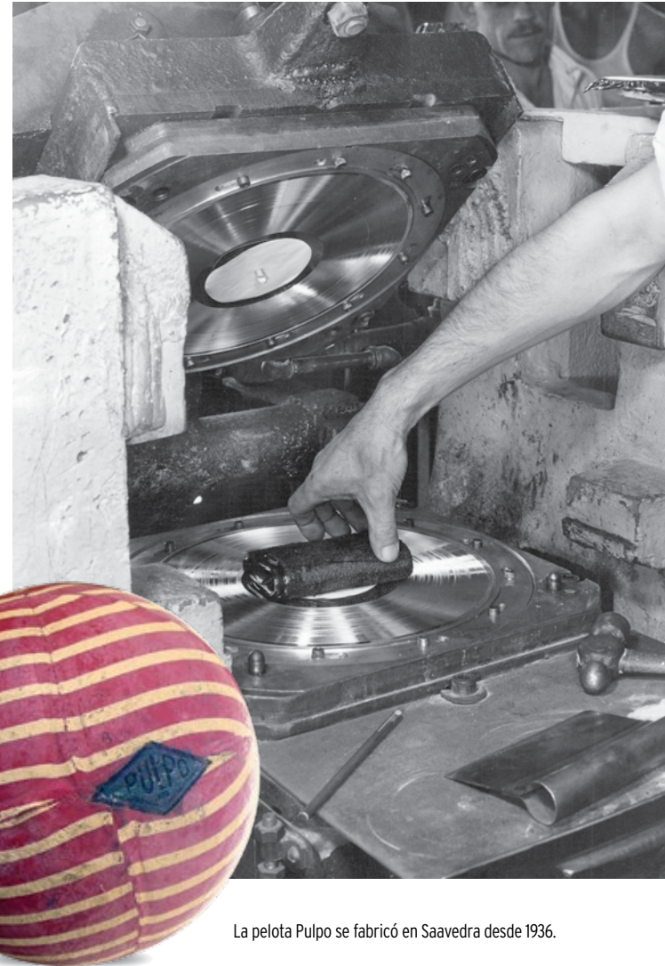
Colocación en la matriz del disco del "bizcocho de pasta" ablandado en el horno lindero. AGN.
