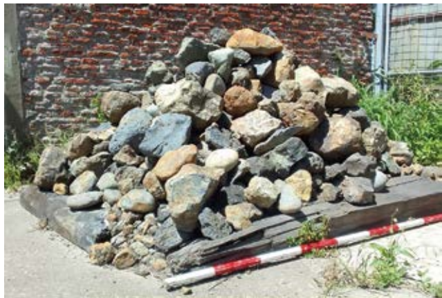
Figura 14. a) Corte de un navío del tipo utilizado entre los siglos XVII y XIX mostrando la posición del lastre para equilibrar la embarcación. b) Piedras pertenecientes al lastre del pecio denominado ZenCity encontrado en el área del puerto de Buenos Aires. Nótese la diversidad de forma, tamaño y composición de los fragmentos (Fotografía gentileza del Dr. M. Weissel)
