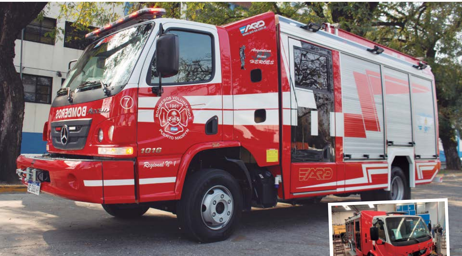
La última adquisición. Móvil 7 "Héroes de Malvinas", Mercedes Benz Accelo 1016/39, unidad de ataque rápido destinada a una primera intervención en incendios estructurales y vehiculares. Se espera que llegue para fines de 2021.
