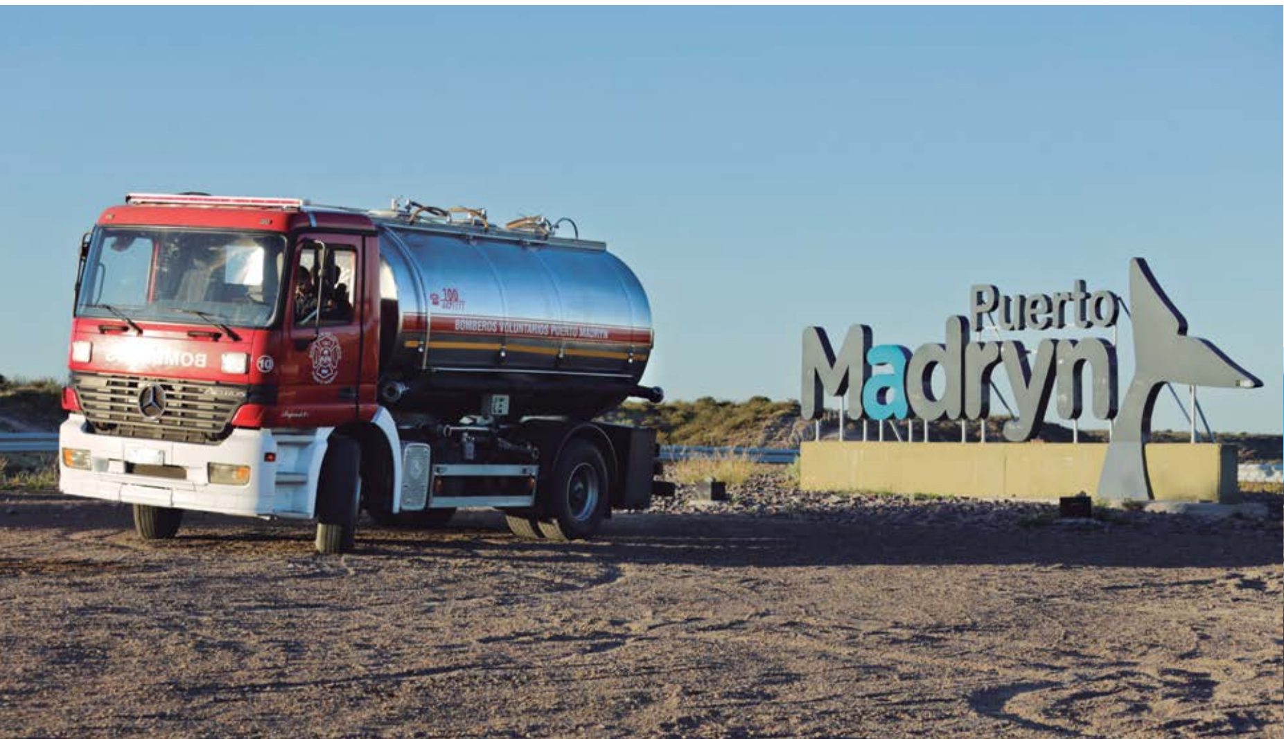
Móvil 10, Mercedes Benz Actros 1831 (1998). Cisterna 10.000 litros. Su existencia responde a la necesidad de contar con provisión de agua en incendios rurales de magnitud como los que se han vivido.
